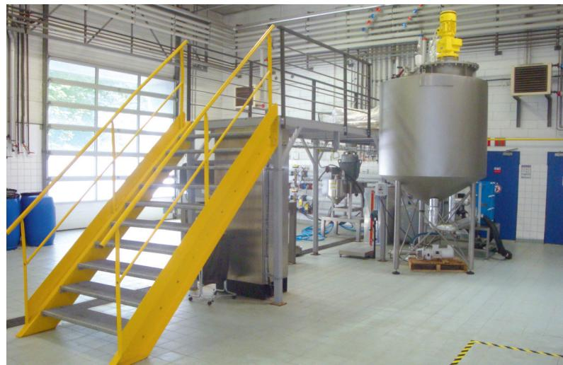
Bolie est équipée depuis juillet 2014 d'une cuve de 3 m<sup>3</sup> qui peut transformer jusqu'à une tonne de matière première par jour (en fonction de la quantité d'eau à ajouter).
